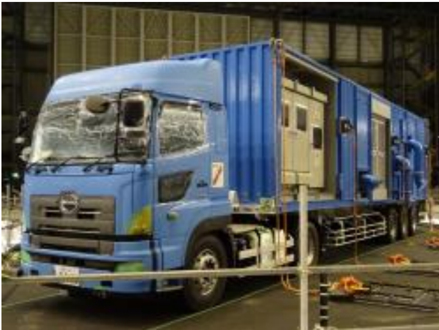
図 3-5 試験構成 (移動式代替熱交換設備) (6/10)
