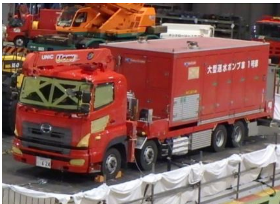
図 3-5 試験構成(大型送水ポンプ車 (原子炉補機代替冷却系及び原子炉建物放水設備用)) (7/10)
