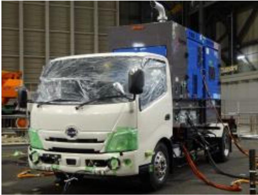
図 3-5 試験構成（緊急時対策所用発電機）（9/10）
