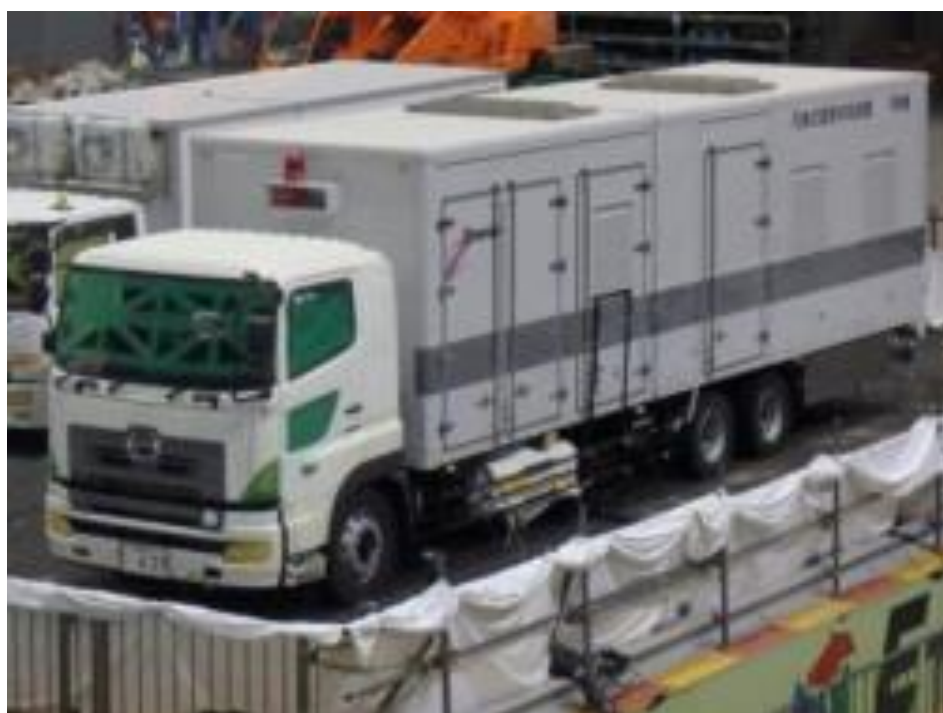
図 3-5 試験構成(可搬式窒素供給装置) (8/10)
