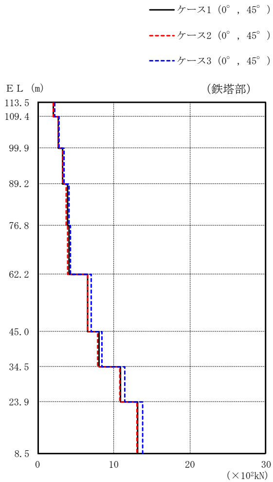
図 2-41(1) 最大応答せん断力 (弾性設計用地震動 S d - N 1 , 水平方向)
