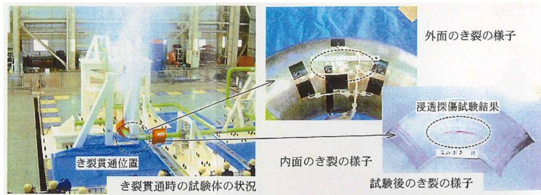
(a) 曲げ管の損傷状況
