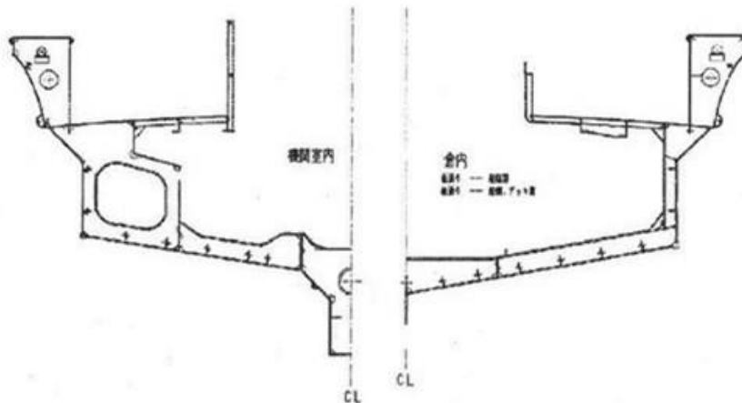
図-2.2 アルミ合金漁船の中央断面図
