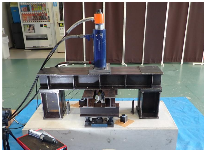
図 5-3 埋設引張試験 (写真)
