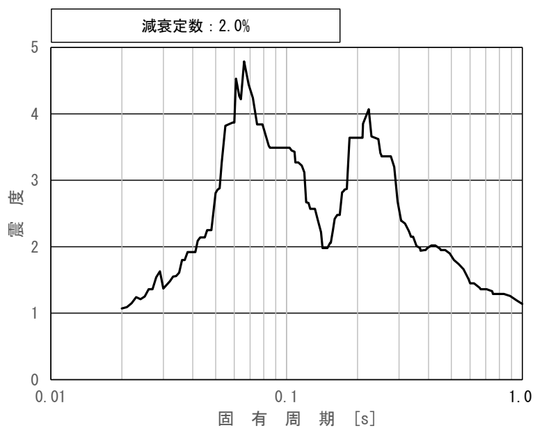
図 2 (6/8) 弁の動的機能維持評価用床応答スペクトル (基準地震動 S_s , 水平方向 (EW) : 原子炉建物 EL15.300m)
