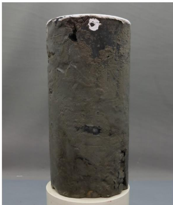
図 2-4 埋戻土における繰返し三軸試験後の供試体写真
