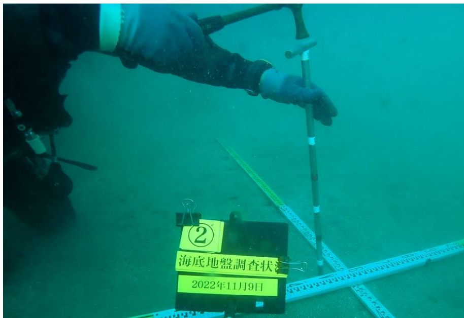
図 2-12 鉄筋棒貫入状況 (ハンマー使用)
