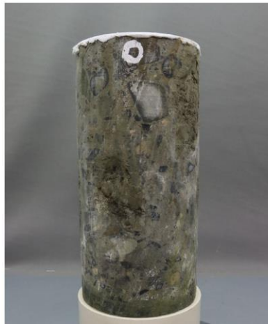
図 4.4.3-3 繰返し三軸試験後の供試体写真（改良地盤⑥）
