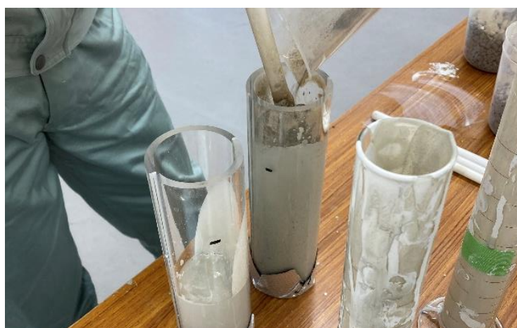
図 4.5.1-5 供試体の作製状況
