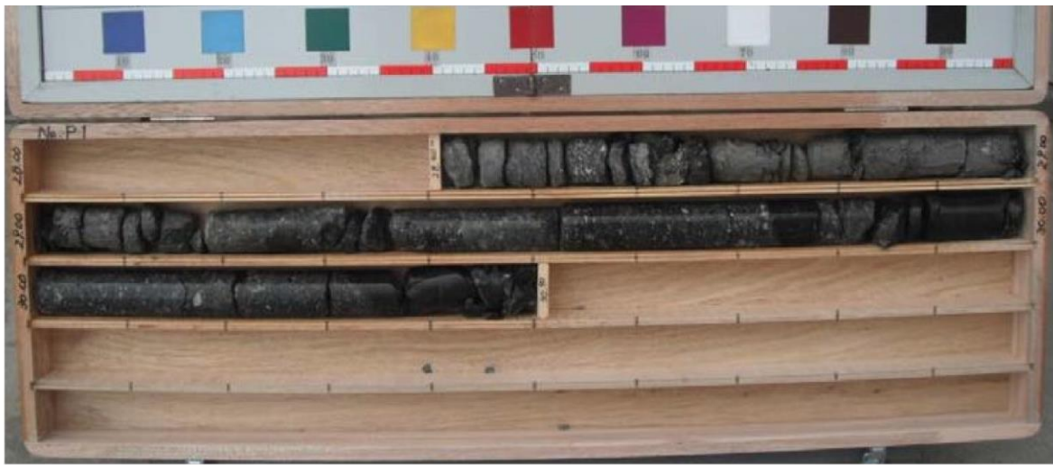
図 1-4 ボーリングコア写真 (P1 : E-1 地点の参考)
