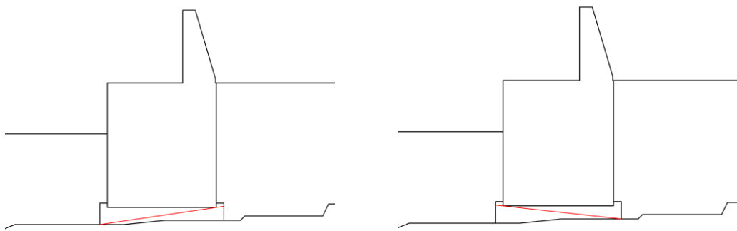
図 4.1.1-25(2) MMRの想定すべり線 (③-③断面)
