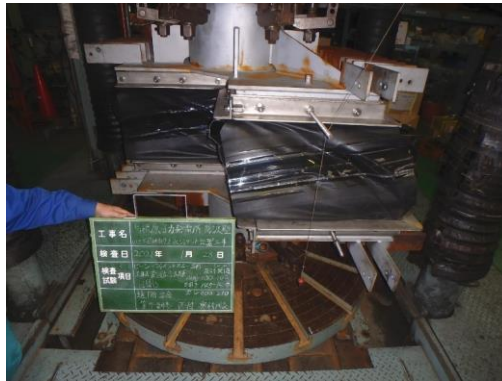
図 2.1-7 止水目地（ゴムジョイント）変形試験 変位後破損無し確認
