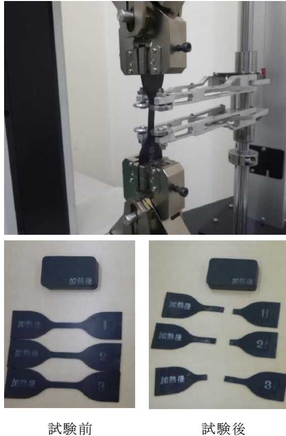
図 2.2-5 止水目地（シートジョイント）引張試験状況及び試験片写真
