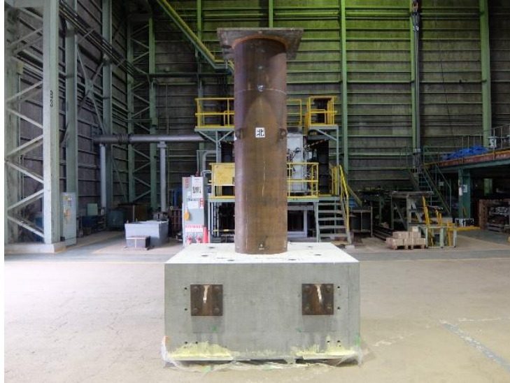
図 2.2.1-2 杭頭載荷実験試験体 (2020 年実施)
