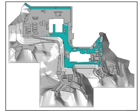
図 3-4 屋外タンク等の溢水伝播挙動
