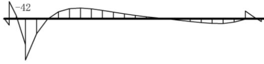
数値：評価位置における断面力 (a) 曲げモーメント (kN・m)
