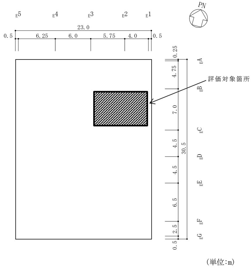
図 4-2 屋根スラブの評価を記載する部材の位置
