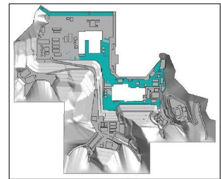
図 3-4 屋外タンク等の溢水伝播挙動
