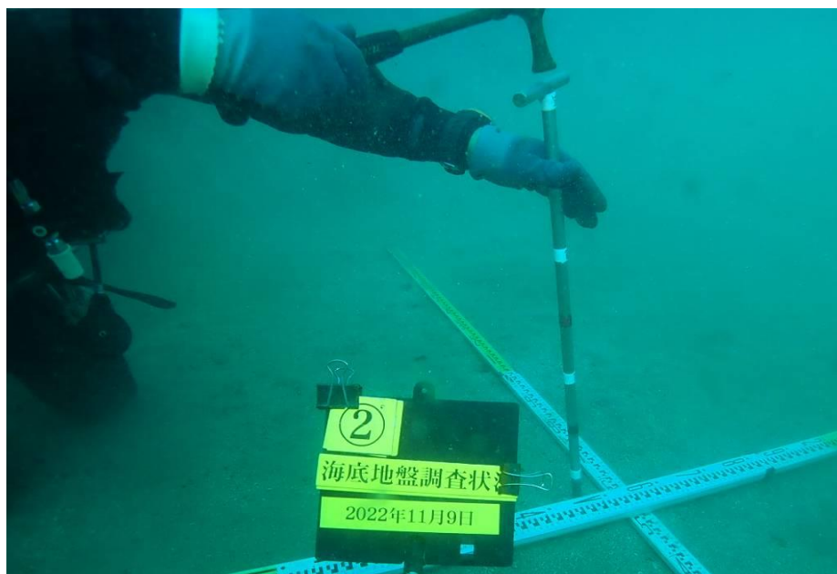
図 2-12 鉄筋棒貫入状況 (ハンマー使用) (参考) 19-11
