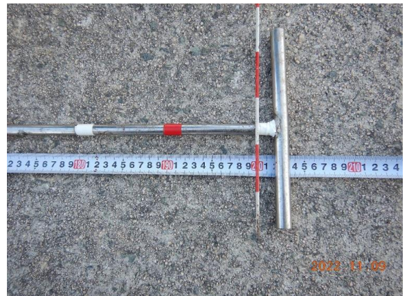
(d) 使用鉄筋棒延長確認
