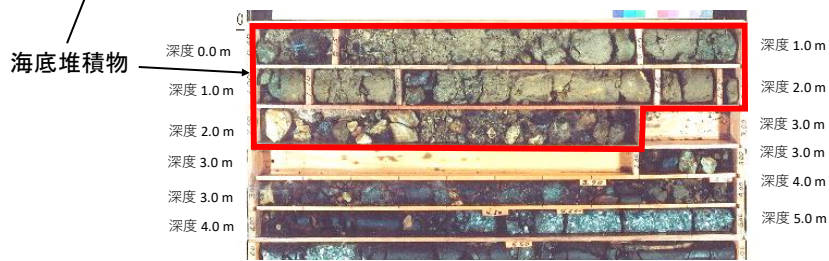
図 2-3 ボーリング結果 (No. 110) (自社調査 (1995))
