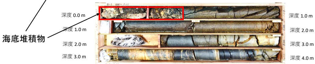
図 2-6 ボーリング結果 (No. B-1) (自社調査 (2012))
