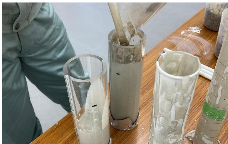
図 4.5.1-5 供試体の作製状況
