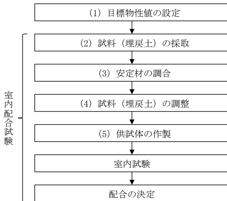
図 4.6.1-1 室内配合試験におけるフロー
