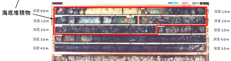
図 2-4 ボーリング結果 (No. 222) (自社調査 (1997))
