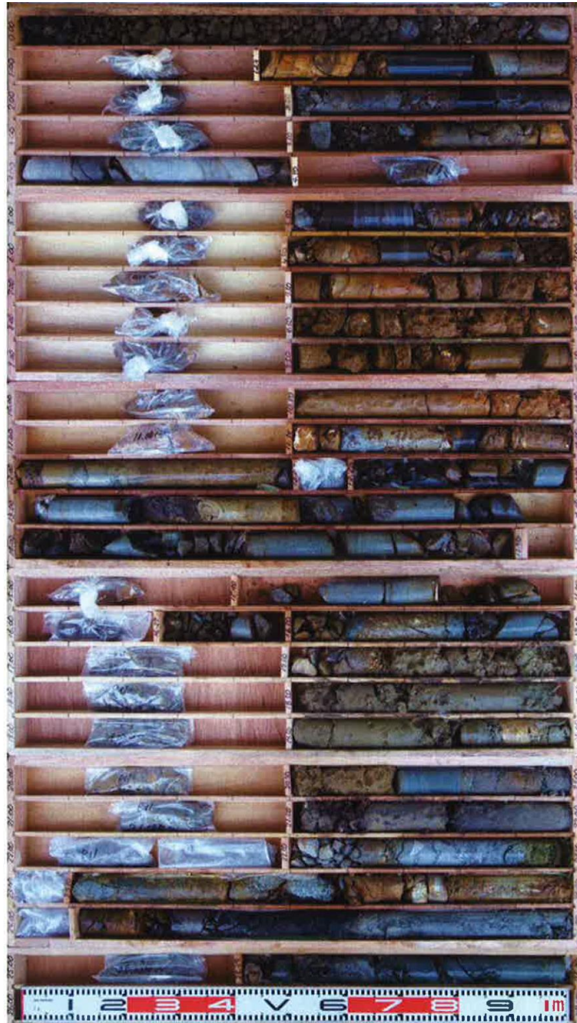
図 1-23 ボーリングコア写真 (P11 : E-7 地点の参考)
