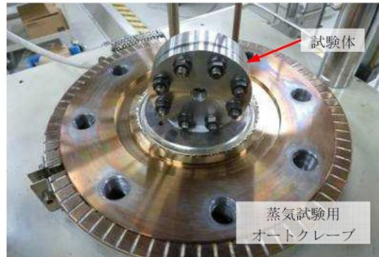
図 2-1 改良 EPDM 製シール材の性能確認試験装置
