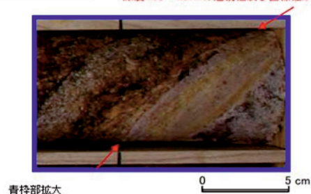
深度4.93~4.97mの連続性及び直線性が良い粘土
