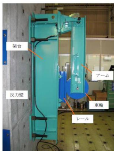
図 1-11 車輪反発係数試験体*
