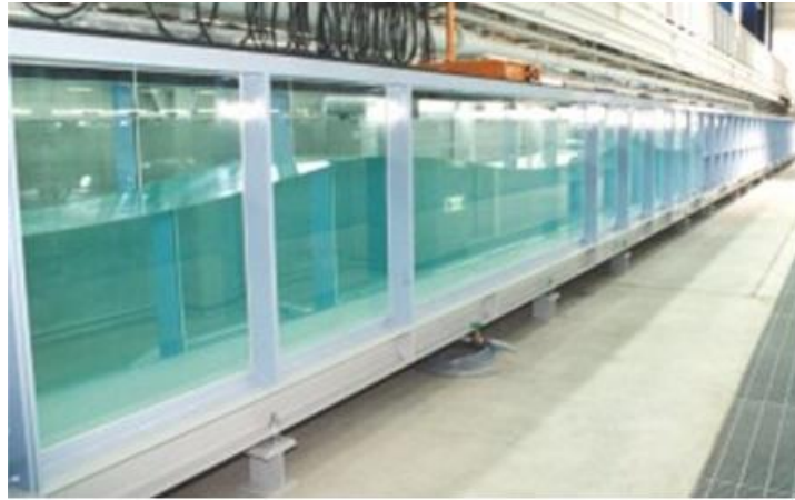
図 1.6.2-12 水理模型実験装置
