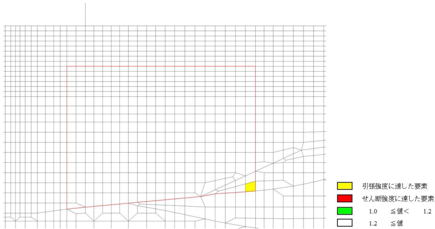
図 6.3-6(11) MMR の引張応力最大時刻の局所安全係数 (S_s - N_2 (EW) (-+) , 解析ケース①, t = 25.94s )
