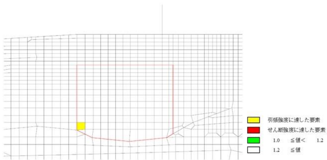
図 6.3-6(4) MMR の引張応力最大時刻の局所安全係数 (S s - D (--) , 解析ケース②, t=8.94s)
