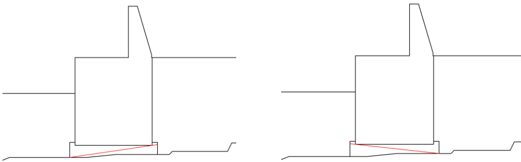
図 4.1.1-25(2) MMRの想定すべり線 (③-③断面)
