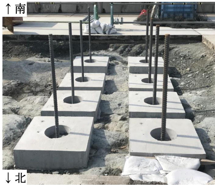
图 4-6 試驗體（右：D51，左：D41，碎石充填前）
