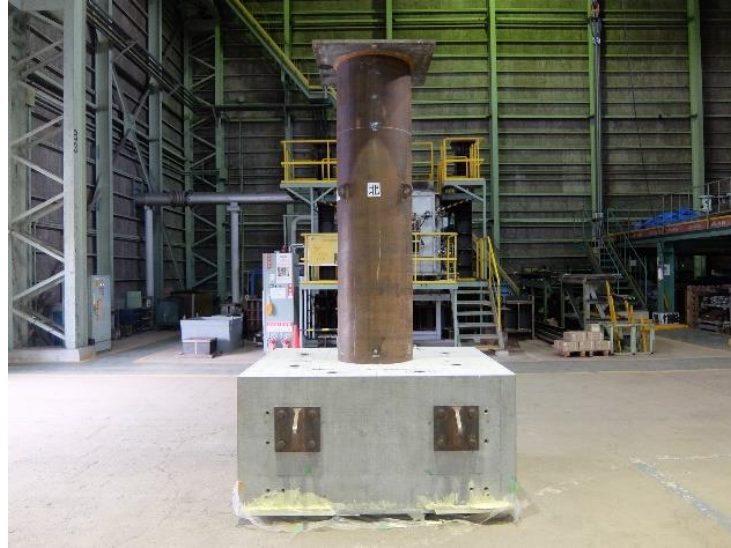
図 2.2.1-2 杭頭載荷実験試験体 (2020 年実施)
