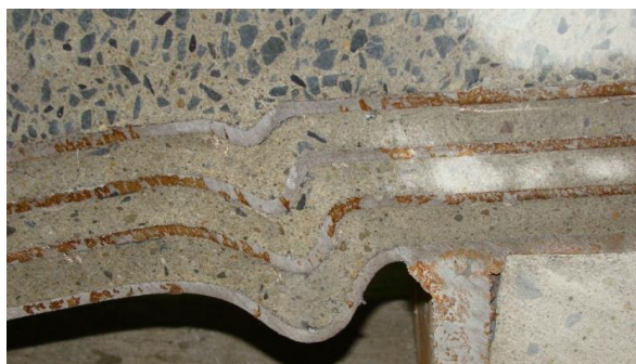
図2 切断面拡大図（圧縮縁）
