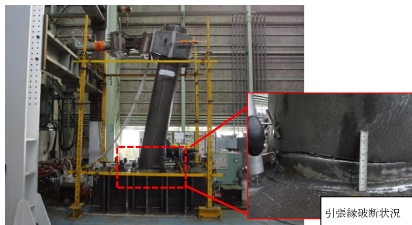
図 2-13 水平載荷実験終了時の状況（実験ケース②）
