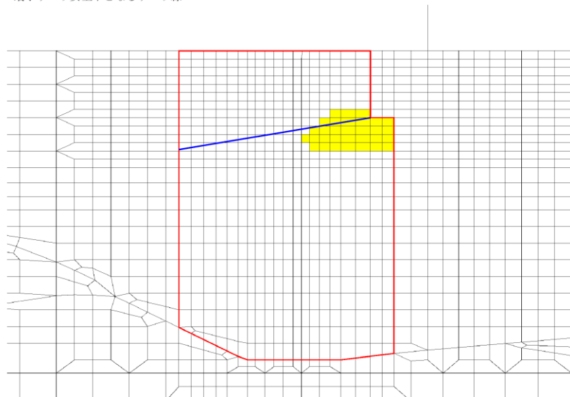
図 6-5 改良地盤の最小すべり安全率時刻における局所安全係数分布 (S s - N 1 (-+), 解析ケース①, t=7.56s)
