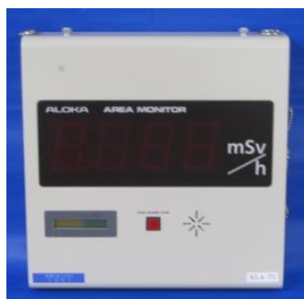
図 2-4 可搬式エリア放射線モニタ
