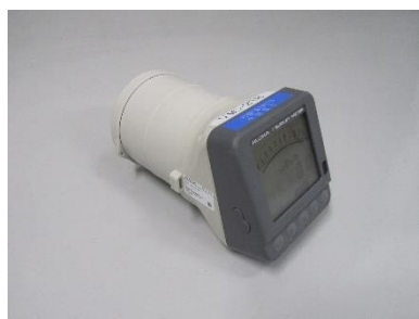
図 2-3 電離箱サーベイメータ
