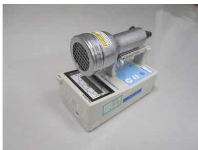
図 2-2 GM汚染サーベイメータ
