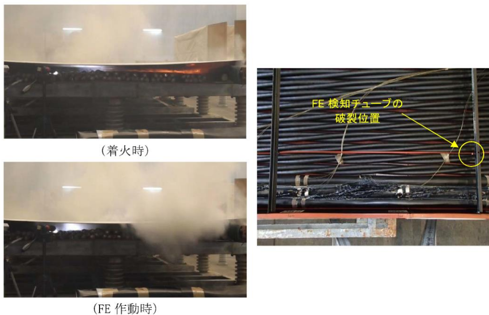
図 9 試験 H2 における発火・消火時の状態
