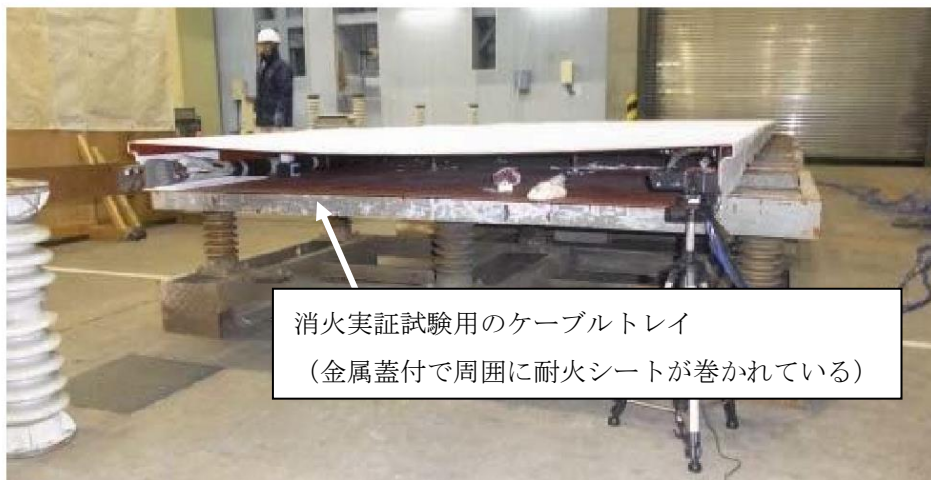
図 5 消火実証試験用のケーブルトレイ外観
