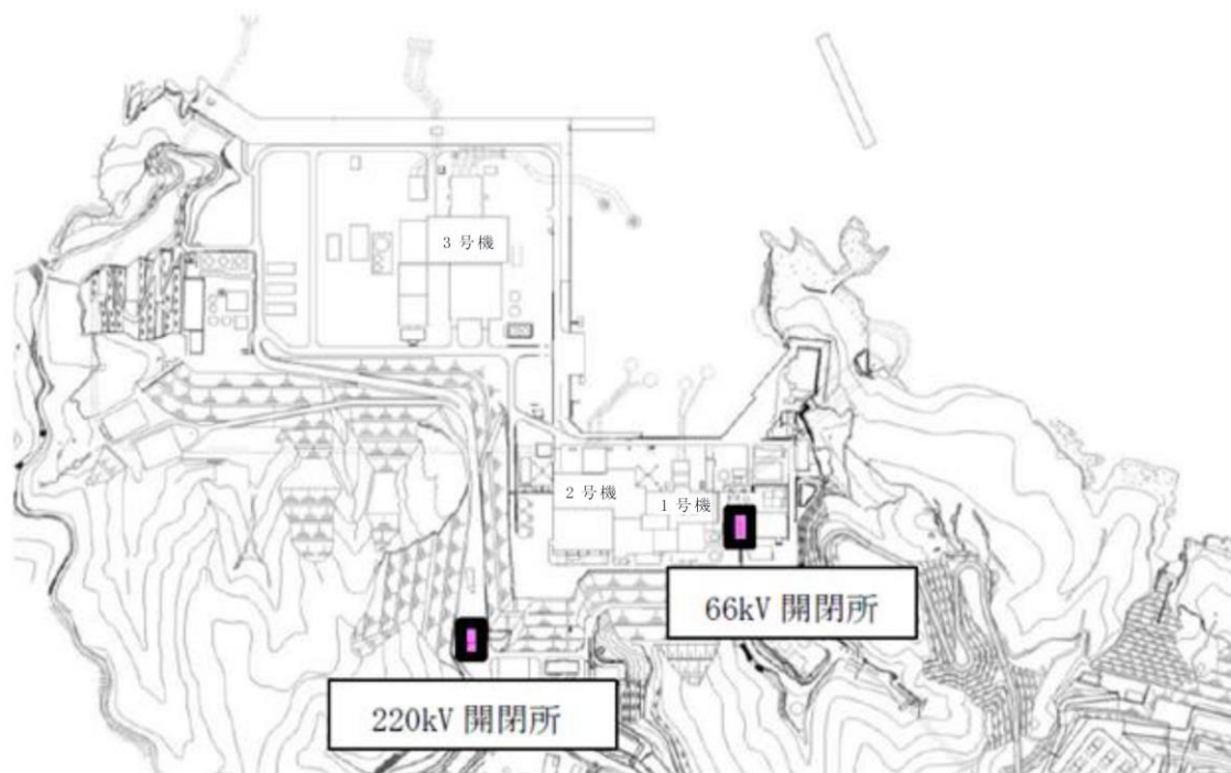
図3-4 開閉所配置図
