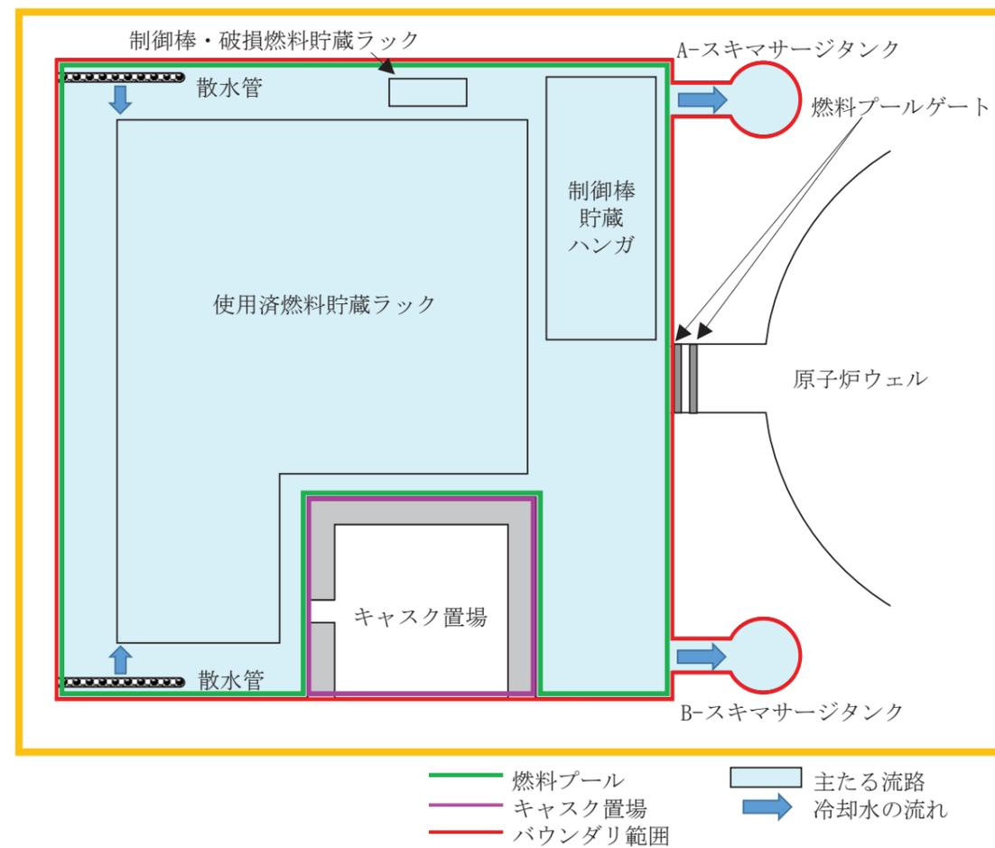
図2 燃料プール廻り配置概要図
