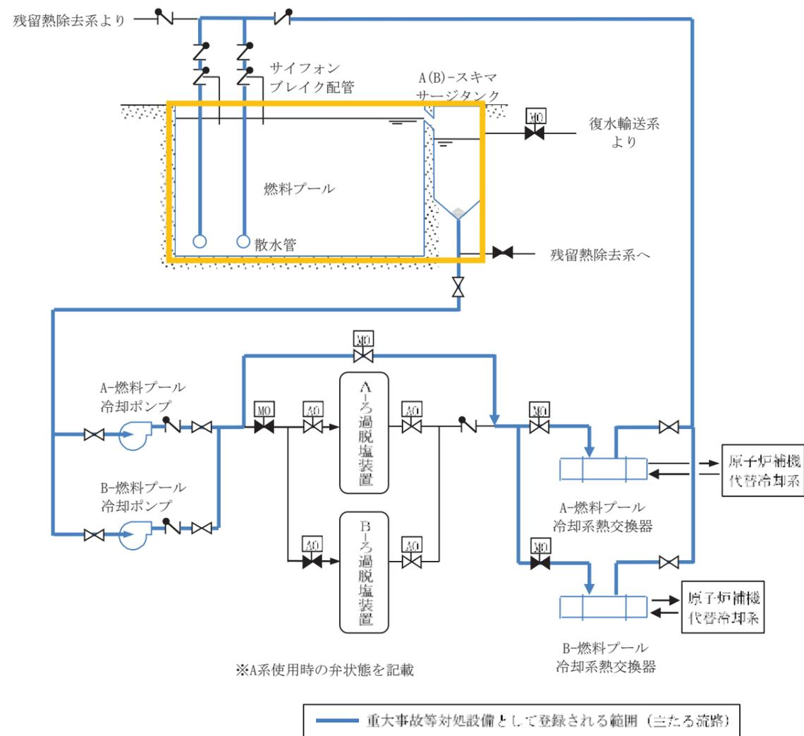
図1 燃料プール冷却系系統概要図
