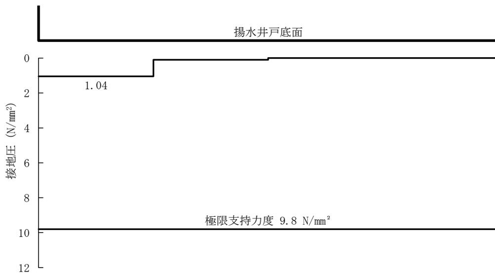
図 5-14 (9) A-A 断面の接地圧分布図 (S<sub>s</sub>-N<sub>2</sub>(NS)(++)) (検討ケース①)
