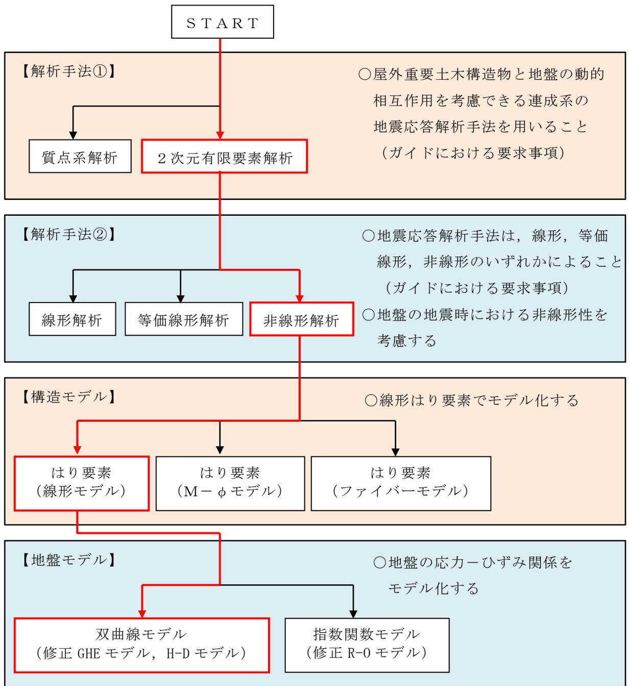
図 3-1 地震応答解析手法の選定フロー
