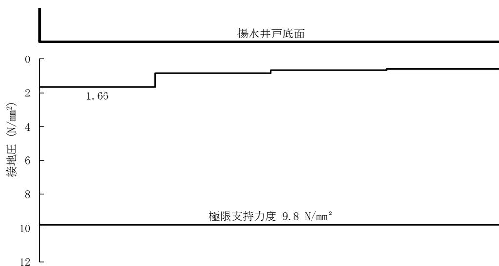
図 5-9 B-B 断面の接地圧分布図 ( $S_s - D (-, +)$ ) (検討ケース①)
