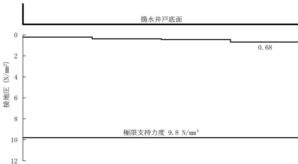
図 5-14 (21) B-B 断面の接地圧分布図 (S<sub>s</sub>-N1 (++) (検討ケース①))
