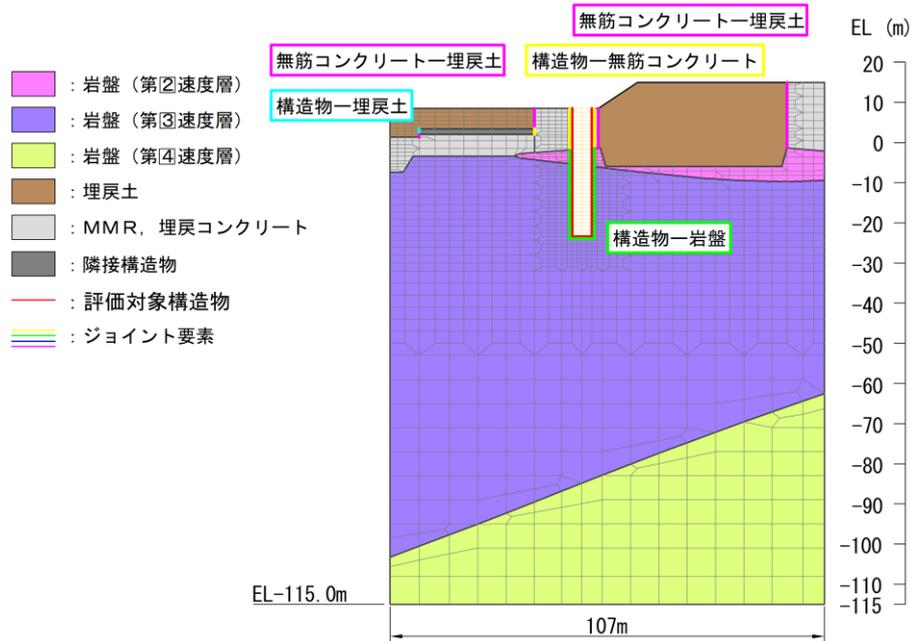
図 3-3 ジョイント要素の配置 (B-B 断面 (南北方向))
