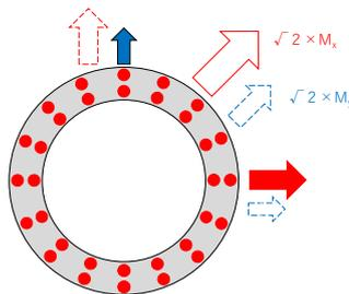
図5-8 曲げモーメントの算定概念図
