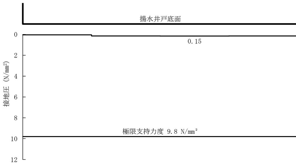
図 5-14 (22) B-B 断面の接地圧分布図 (S<sub>s</sub>-N1 (-+)) (検討ケース①))
