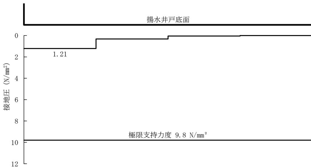
図 5-14 (13) A-A断面の接地圧分布図 (S<sub>s</sub>-N1 (-+)) (検討ケース②)
