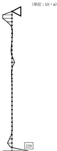
図 5-11 (2) 側壁はりモデルにおける曲げモーメント図
