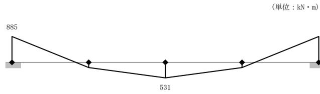
図 5-12 (1) 底版はりモデルにおける曲げモーメント図
