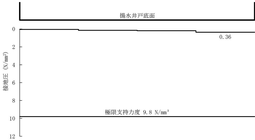
図 5-14 (20) B-B 断面の接地圧分布図 (S<sub>s</sub>-F 2 (++) (検討ケース①))
