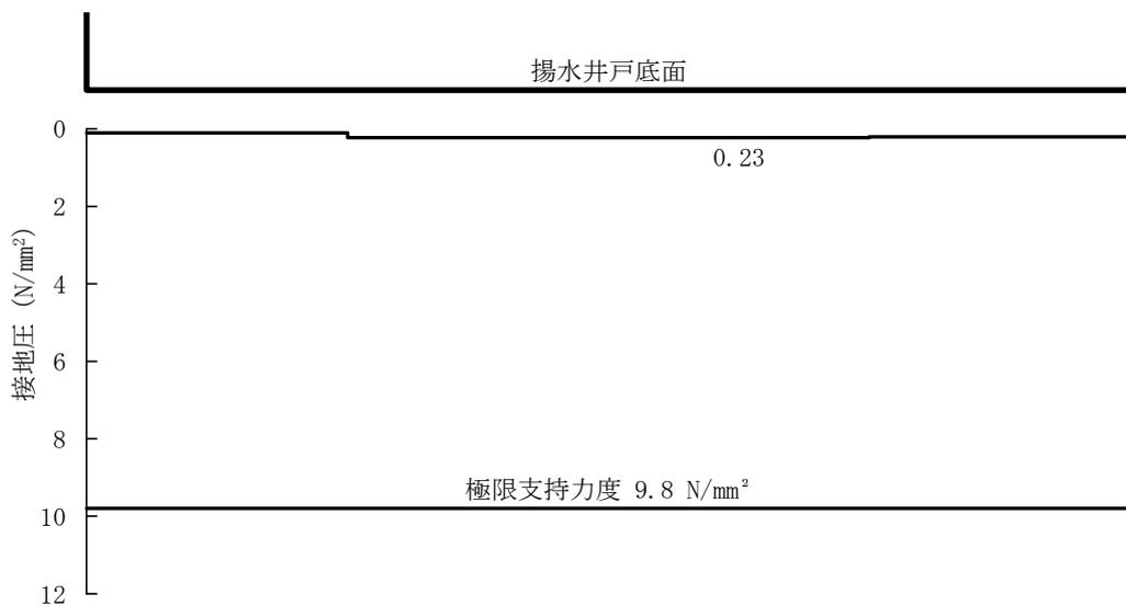
図 5-14 (27) B-B 断面の接地圧分布図 (S<sub>s</sub>-N1 (++) (検討ケース②))
