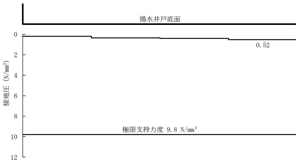
図 5-14 (28) B-B 断面の接地圧分布図 (S<sub>s</sub>-N1 (++) (検討ケース③))
