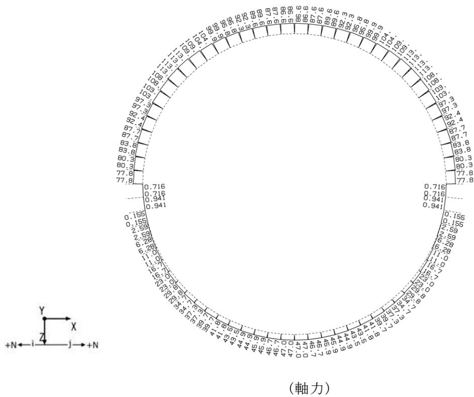
図 5-6 (4) コンクリート及び鉄筋の曲げ軸力が最も厳しい時刻の断面力 (B-B断面, 上部,  $S_s - N_2$  (NS), (+, +),  $t = 25.11$  s) (検討ケース①)
