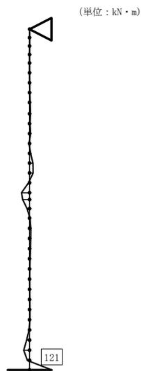
図 5-11 (4) 側壁はりモデルにおける曲げモーメント図
