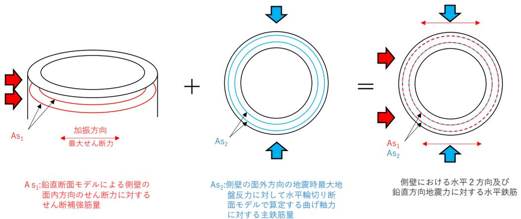
図4-17 側壁の水平鉄筋の設計イメージ
