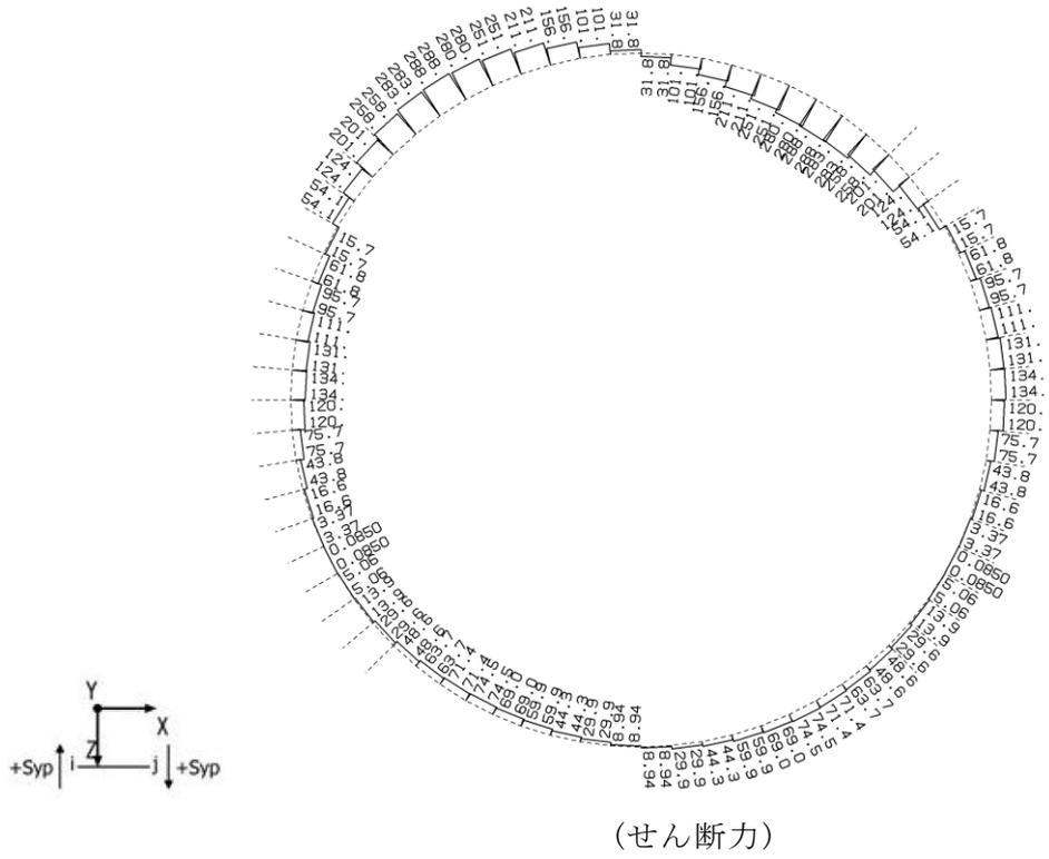
図 5-8 (6) コンクリートのせん断力が最も厳しい時刻の断面力
