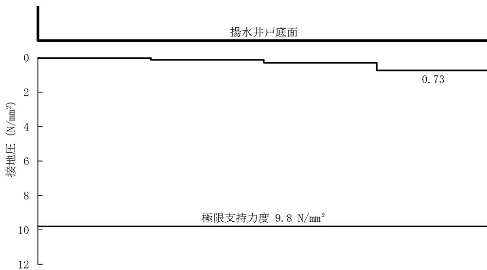
図 5-14 (10) A-A 断面の接地圧分布図 (S<sub>s</sub>-N<sub>2</sub>(NS)(-+)) (検討ケース①)
