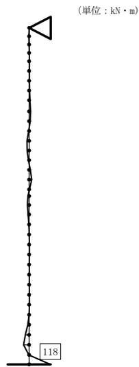
図 5-11 (3) 側壁はりモデルにおける曲げモーメント図
