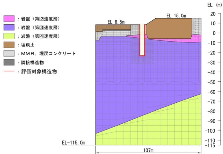
図 3-2 地震応答解析モデル図 (B-B 断面 (南北方向))
