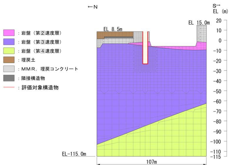
図3-11 (2) 地震応答解析モデル図 (B-B断面 (南北方向))
