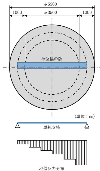
図 4-18 底版の応答解析概念図
