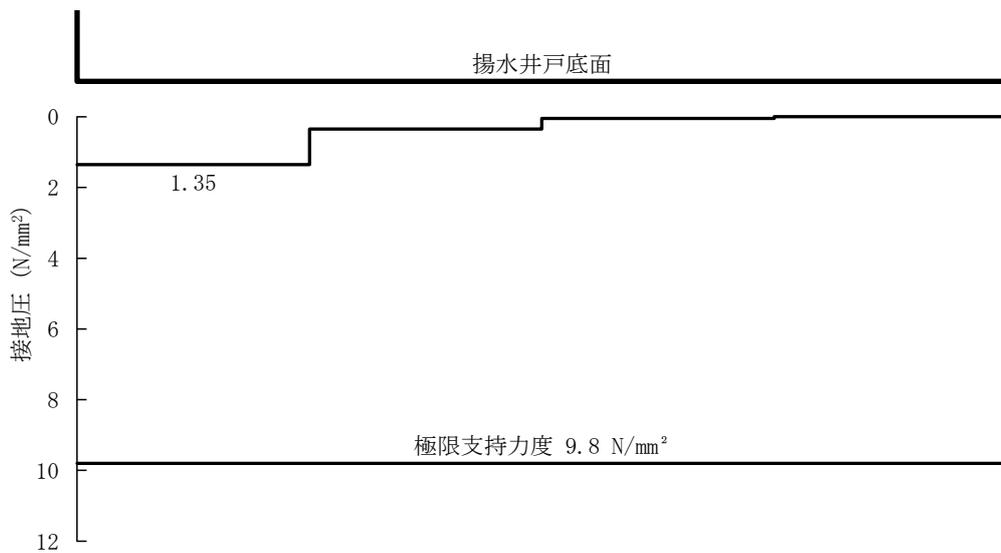
図 5-14 (8) A-A 断面の接地圧分布図 (S<sub>s</sub>-N1(-+))(検討ケース①)
