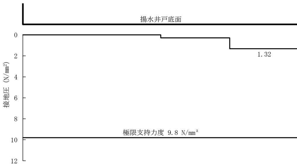
図 5-14 (7) A-A 断面の接地圧分布図 (S<sub>s</sub>-N1(++))(検討ケース①)
