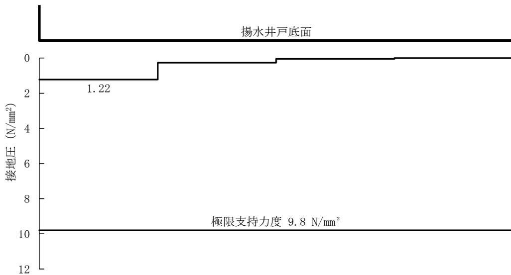
図 5-14 (14) A-A断面の接地圧分布図 (S<sub>s</sub>-N1 (-+)) (検討ケース③)
