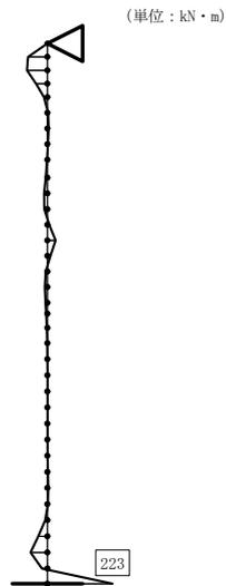
図 5-11 (1) 側壁はりモデルにおける曲げモーメント図
