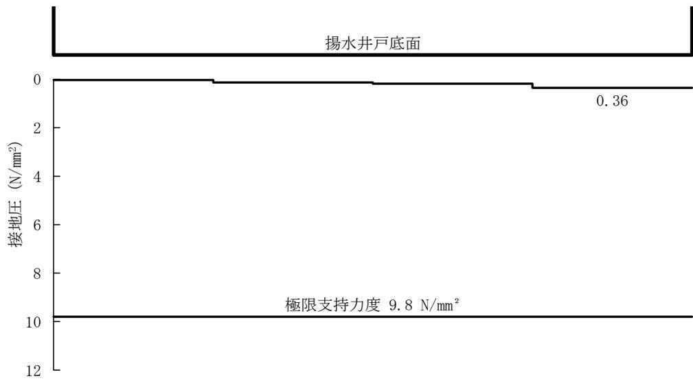
図 5-14 (19) B-B 断面の接地圧分布図 (S<sub>s</sub>-F 1 (++) (検討ケース①))
