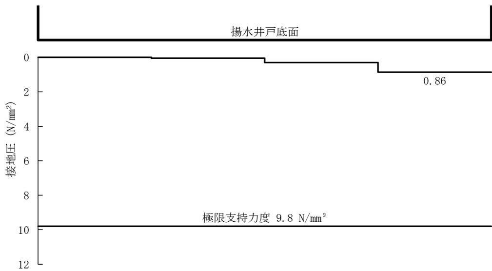
図 5-14 (5) A-A 断面の接地圧分布図 (S<sub>s</sub>-F1 (++) (検討ケース①))
