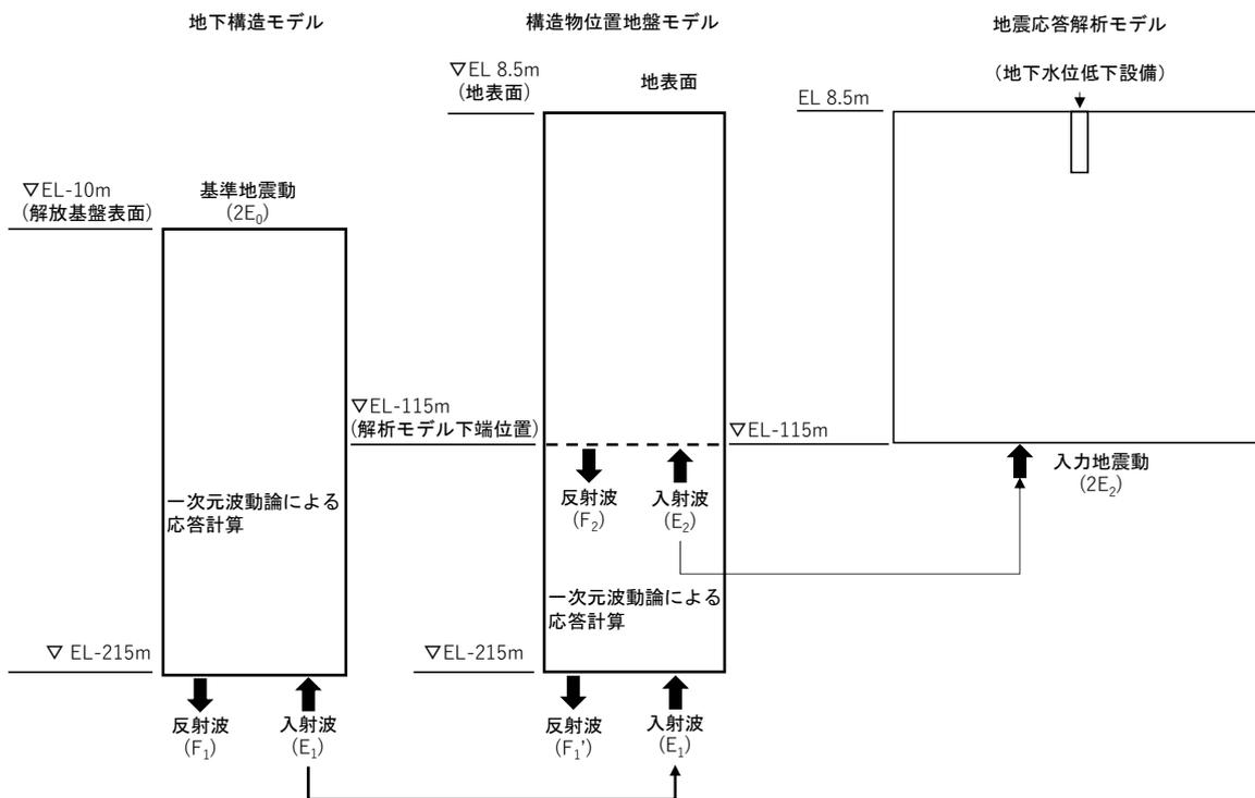
図4-1 入力地震動算定の概念図
