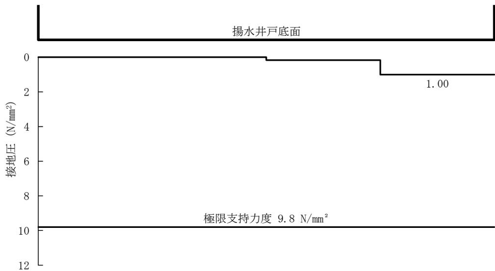
図 5-14 (6) A-A 断面の接地圧分布図 (S<sub>s</sub>-F2 (++) (検討ケース①))
