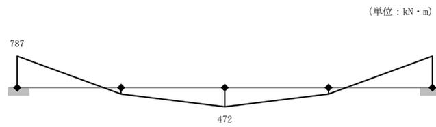
図 5-12 (2) 底版はりモデルにおける曲げモーメント図
