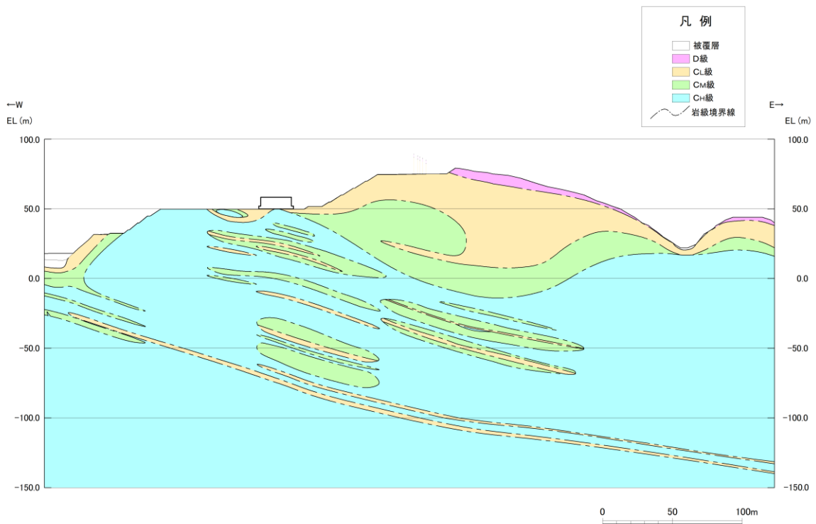
図3(1) 地質断面図 (岩級図)
