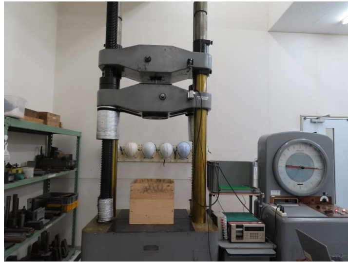
図 5-2 母材引張試験 (写真)
