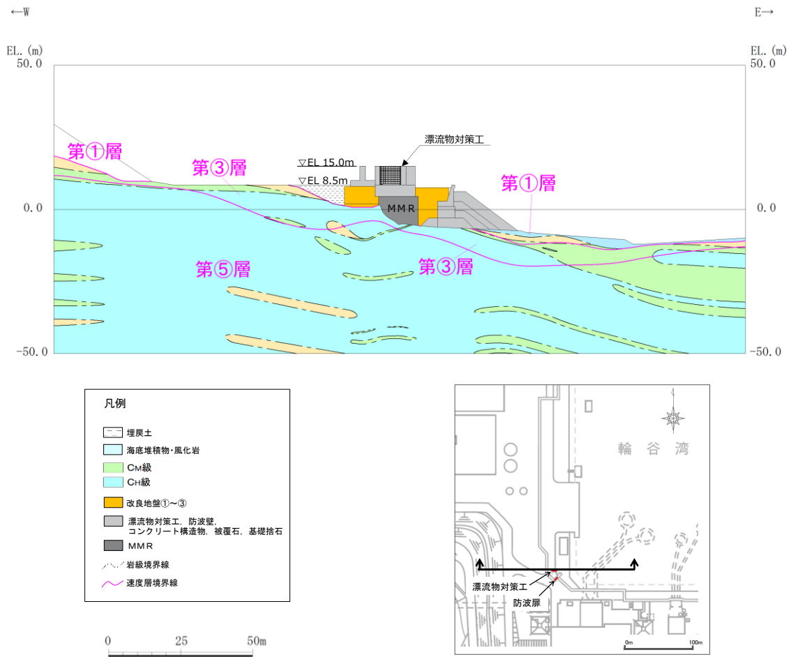
図 4.2-3 漂流物対策工の扉体軸方向断面図
