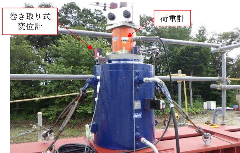
図 3.3-10 模型実験における計測機器設置状況
