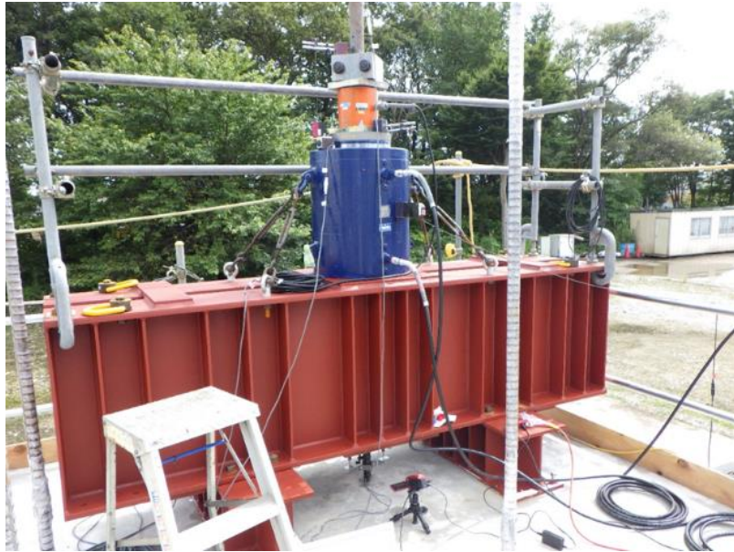
図 3.3-9 模型実験における荷重載荷装置
