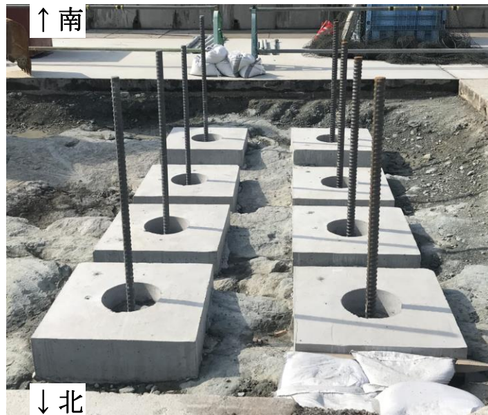
图 4-6 試驗體（右：D51，左：D41，碎石充填前）
