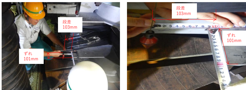
ずれ量・段差量確認
