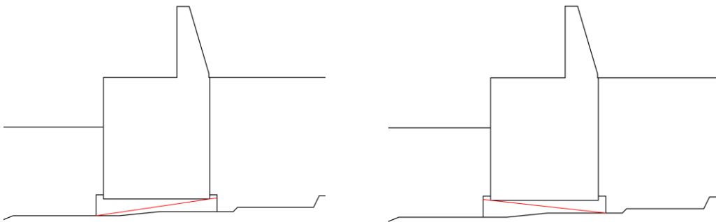
図 4.1.1-25(3) MMRの想定すべり線 (④-④断面)
