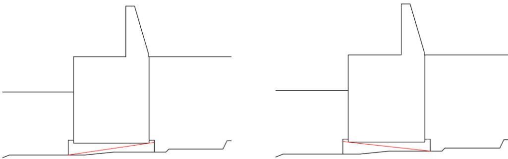
図 4.1.8-4(2) MMR の想定すべり線 (③-③断面)
