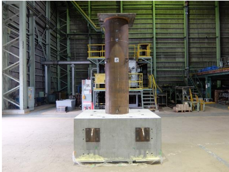
図 2.2.1-2 杭頭載荷実験試験体 (2020 年実施)
