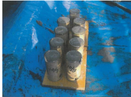
図 4-7 グラウトの一軸圧縮強度試験テストピース
