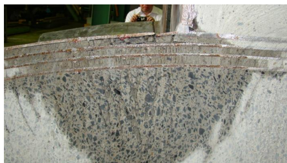
図3 切断面拡大図（引張縁）
