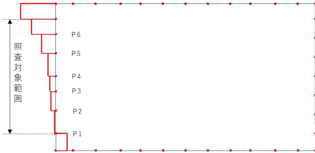
図 4-7 せん断力分布図 (C-C断面, 側壁)
