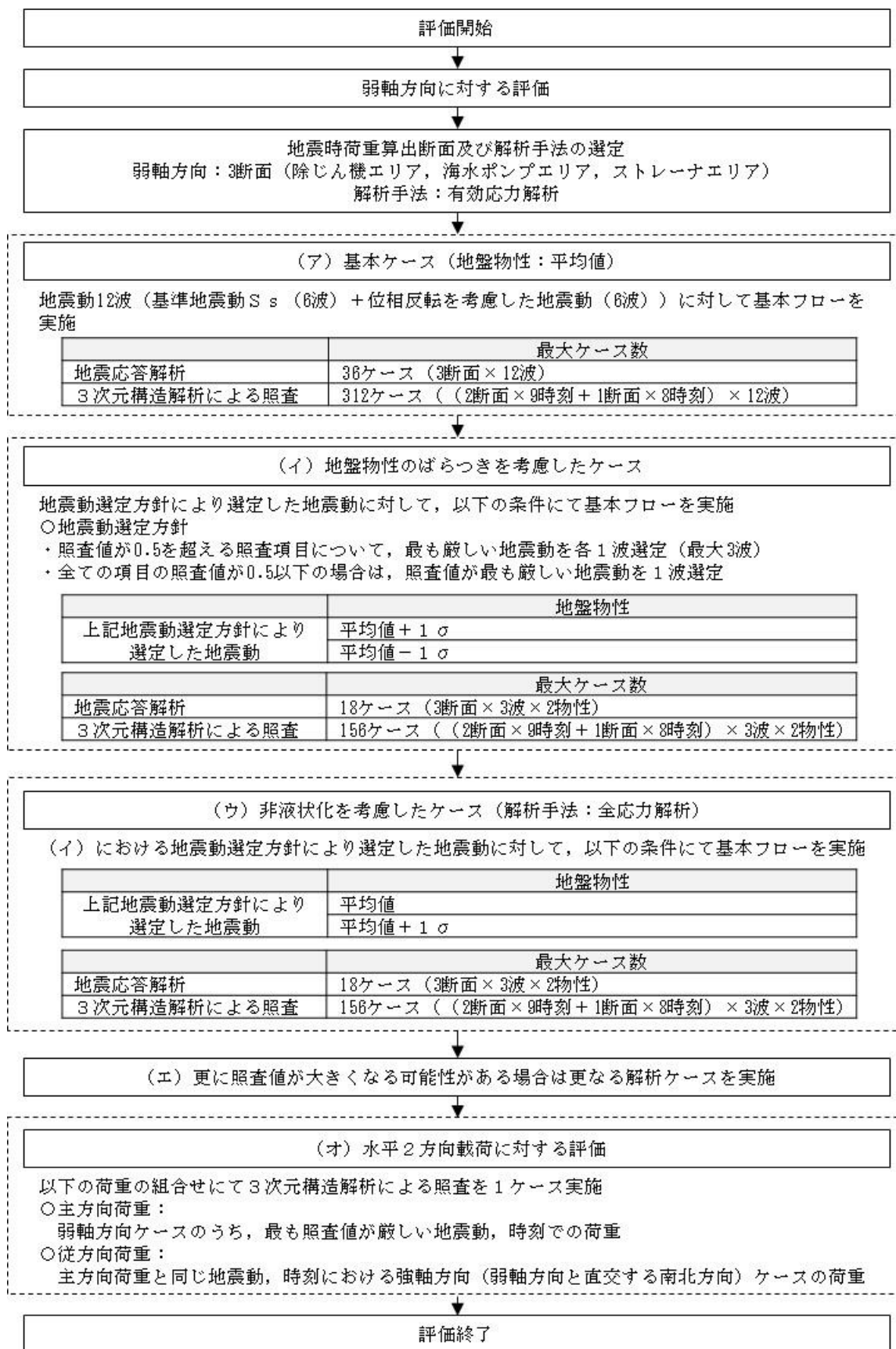
図 2-25 取水槽の3次元構造解析フロー
