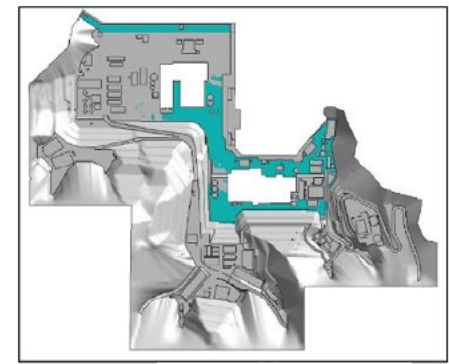
図 3-4 屋外タンク等の溢水伝播挙動
