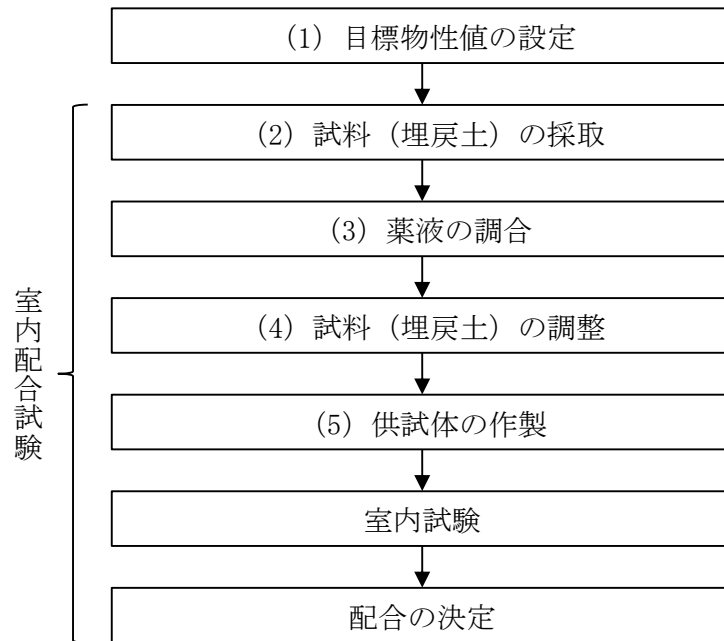
図 4.5.1-1 室内配合試験におけるフロー
