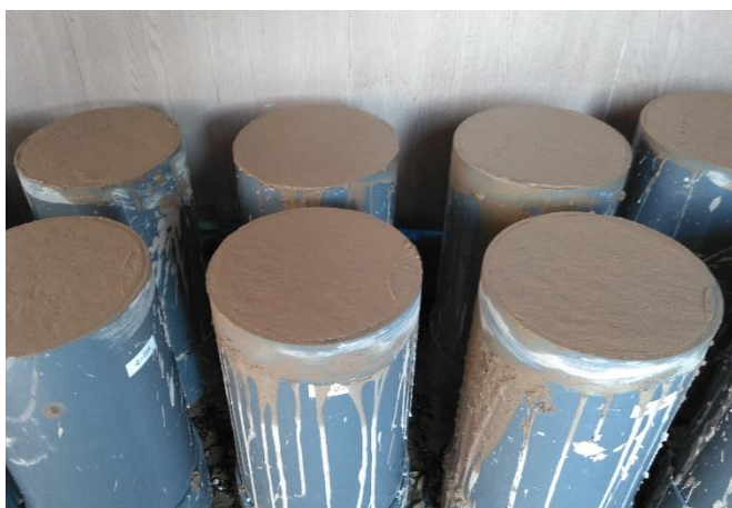
改良地盤⑧の供試体の養生状況 (供試体寸法：直径20cm×高さ40cm)
