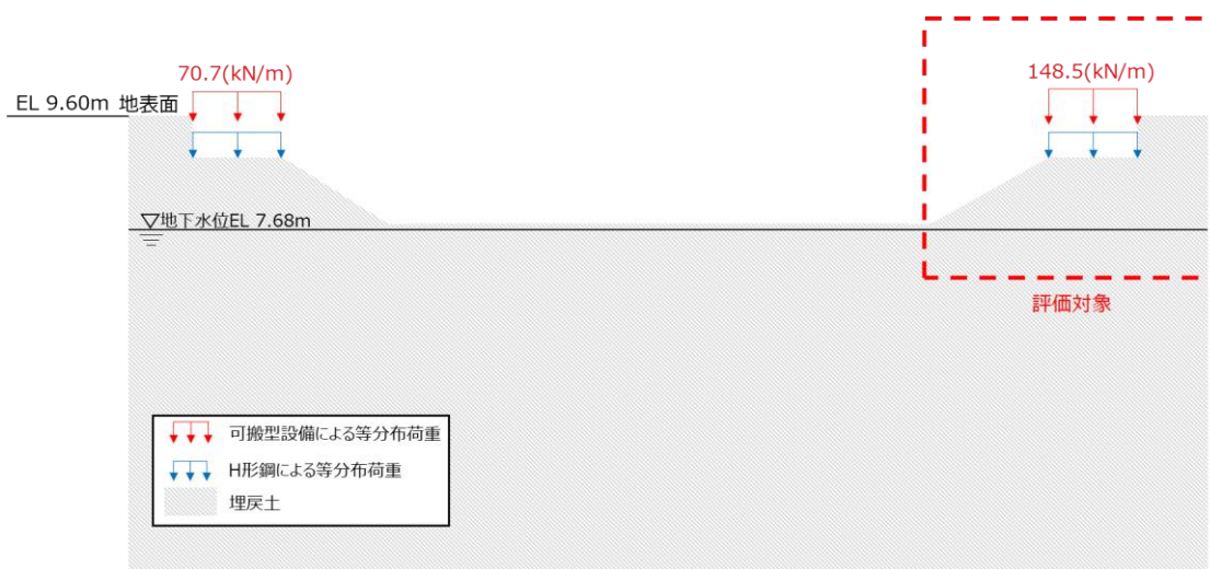
図 2-1 解析モデルの概要図
