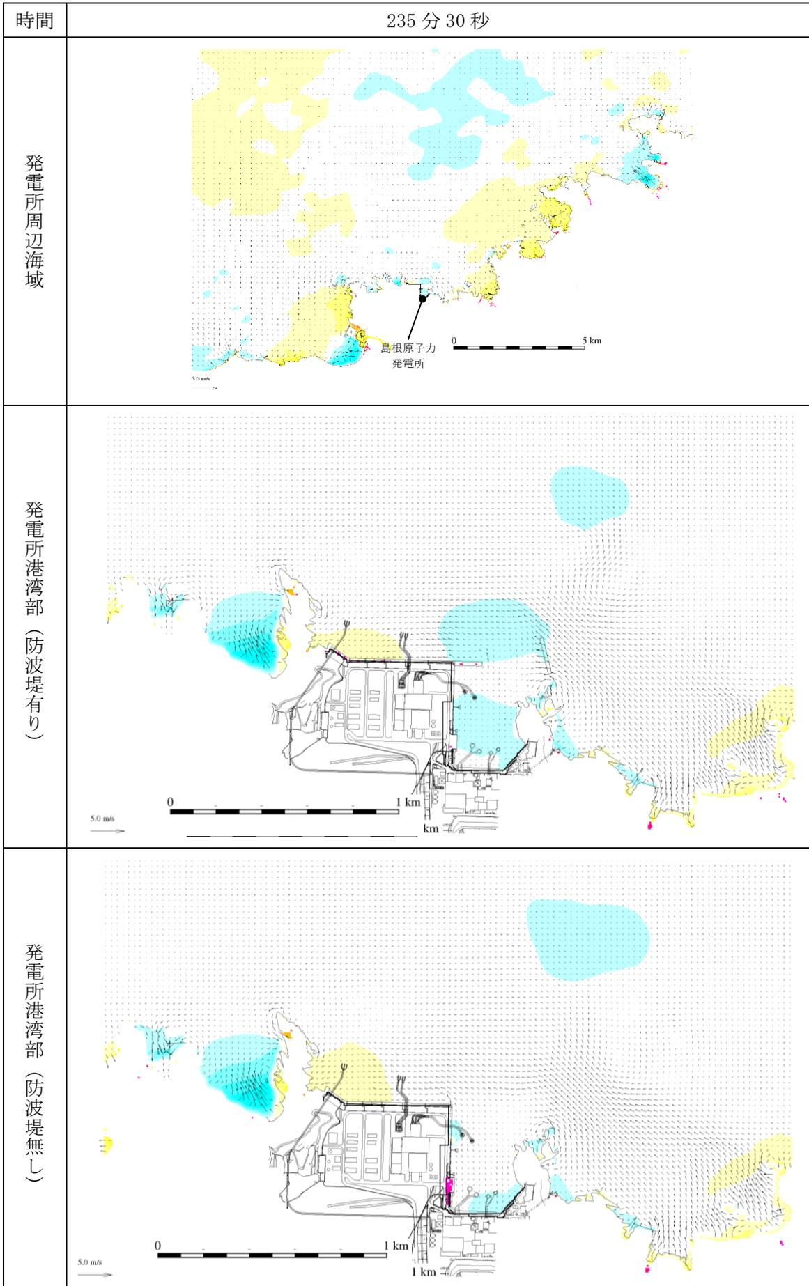
図 1-272 基準津波 1 の水位変動・流向ベクトル
