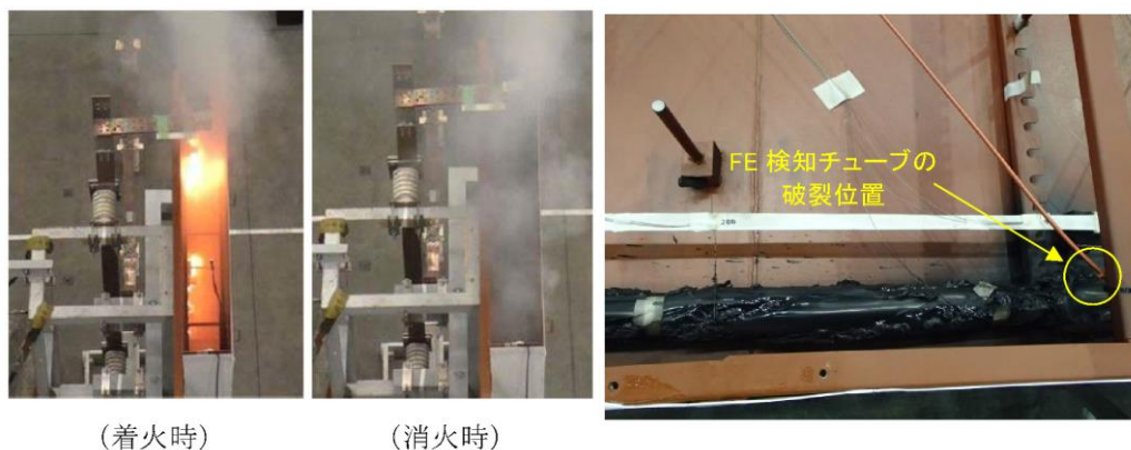
図 11 試験 V1 における発火・消火時の状態
