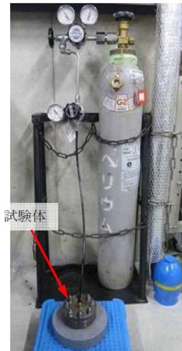
図5 He気密確認試験状況
