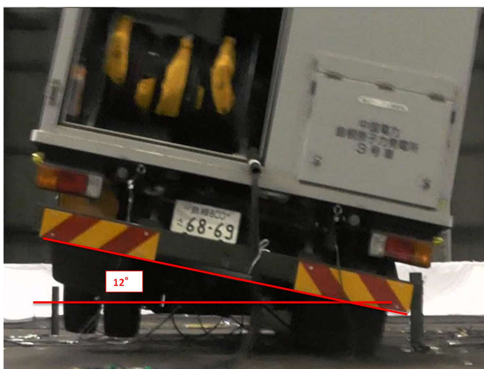
図 6-1 高圧発電機車（タイプ I）の最大傾き角の計測結果
