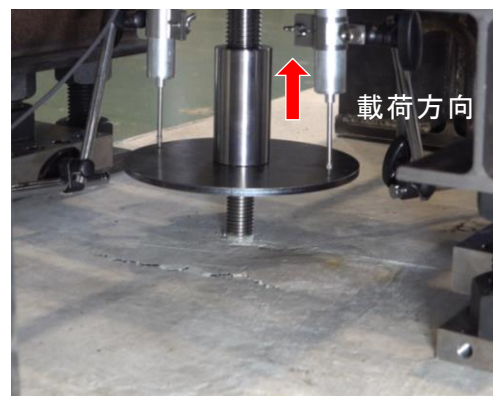
(参考) コンクリートのひび割れ状況
