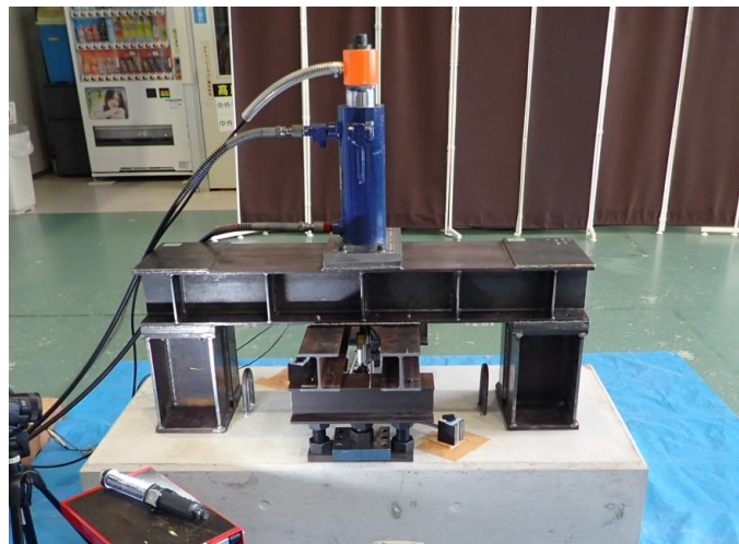
図 5-3 埋設引張試験 (写真)
