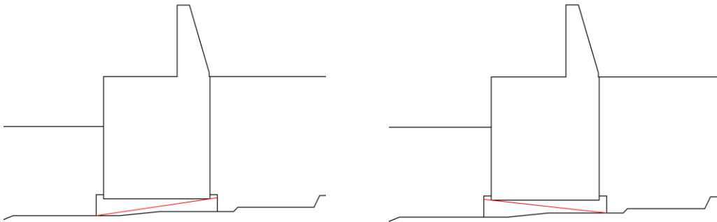
図 4.1.1-25(3) MMRの想定すべり線 (④-④断面)
