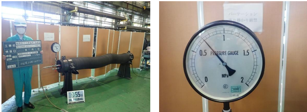
図 2.2-7 止水目地（シートジョイント）の耐圧試験状況（加圧後状況）
