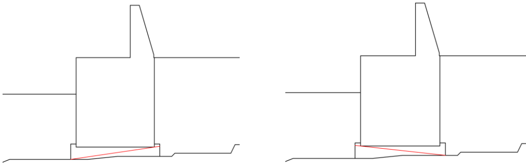
図 4.1.1-25(2) MMRの想定すべり線 (③-③断面)
