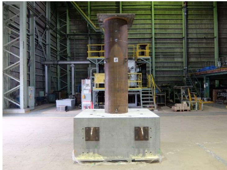
図 2.2.1-2 杭頭載荷実験試験体 (2020 年実施)
