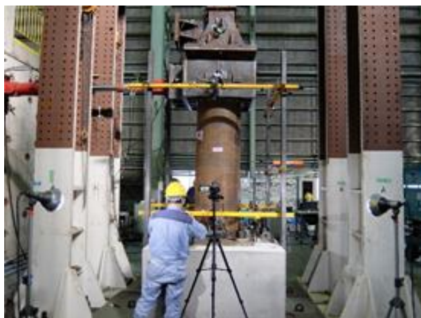
図 2.2.2-2 載荷実験状況
